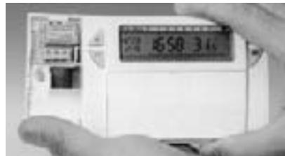
**2** Bevestig de achterplaat van de thermostaat aan de muur en sluit de bedrading aan volgens onderstaand schema. (Bij 2-draads kabel de klemmen 1 en 3)
